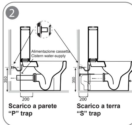
2 - Montare il meccanismo di scarico nella cassetta. Predisporre le connessioni di scarico seguendo le indicazioni mostrate nel dettaglio ingrandito. Sistemare il vaso nei perni e spingerlo verso la parete assicurandosi che tutte le connessioni combacino perfettamente. Per facilitare la connessione si suggerisce di lubrificare entrambe le parti.
