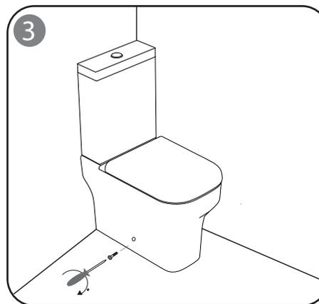
3 - Livellare il vaso e fissarlo utilizzando le apposite viti. Al fine di ottenere una installazione corretta alla parete, si consiglia di alternare l'avvitamento.
