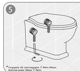
5 - Fissare il vaso sospeso mediante i dadi di fissaggio. Si consiglia di avvitare alternativamente i dadi in modo da ottenere un fissaggio migliore del vaso alla parete.
