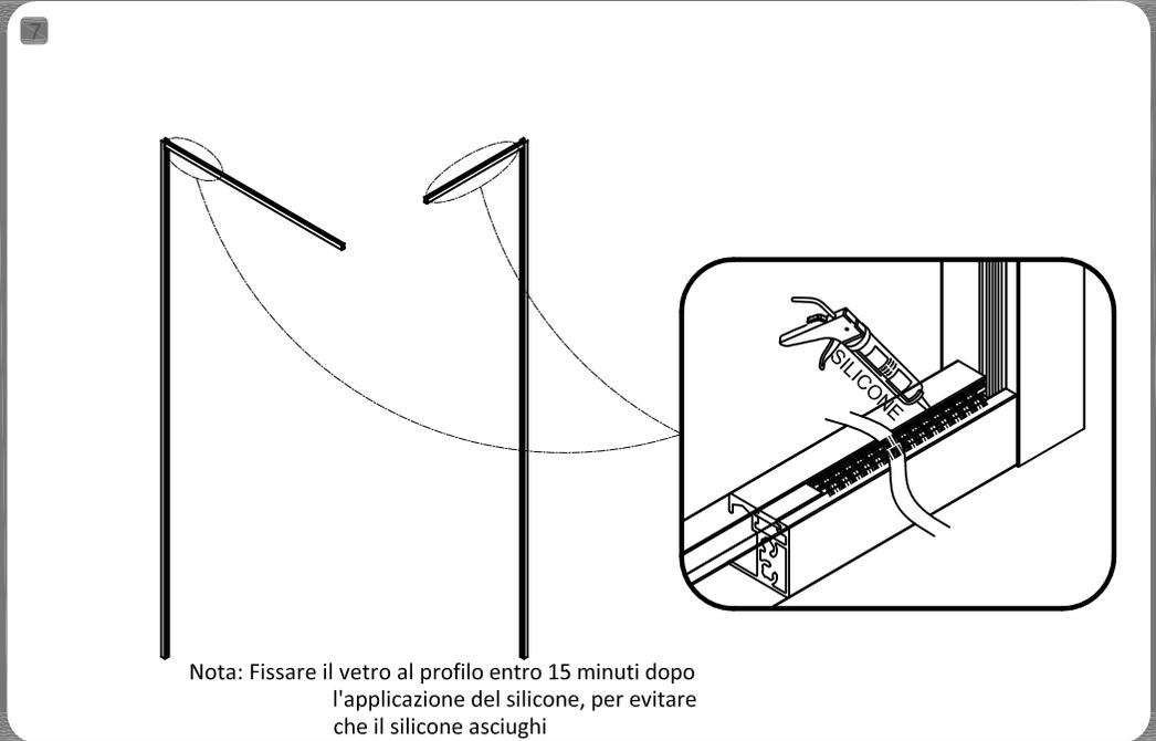
Nota: Fissare il vetro al profilo entro 15 minuti dopo l'applicazione del silicone, per evitare che il silicone asciughi
