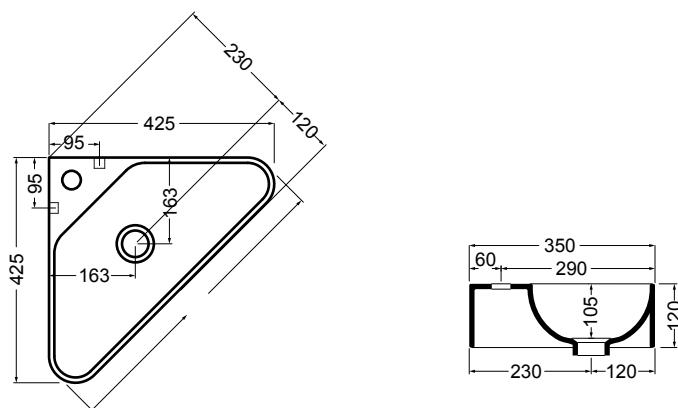
N.B.: Le misure indicate possono subire una variazione dello 0,8 % circa, dovuta ad usura stampi o a piccole variazioni delle caratteristiche tecniche relative alle materie prime che compongono l' impasto.
