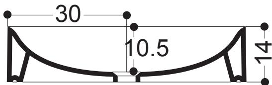
N.B.: Le misure indicate possono subire una variazione dello 0,8 % circa, dovuta ad usura stampi o a piccole variazioni delle caratteristiche tecniche relative alle materie prime che compongono l' impasto.
