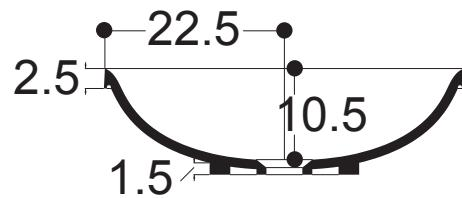
N.B.: Le misure indicate possono subire una variazione dello 0,8 % circa, dovuta ad usura stampi o a piccole variazioni delle caratteristiche tecniche relative alle materie prime che compongono l' impasto.
