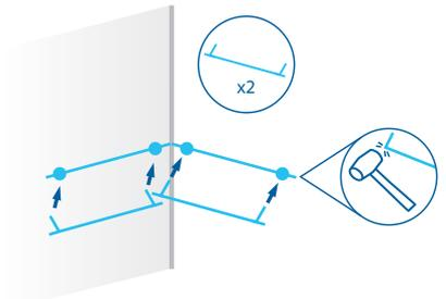
Prendre les deux supports en acier (A - fournis) et les insérer dans les bouchons sous pression, en utilisant un marteau en caoutchouc.
