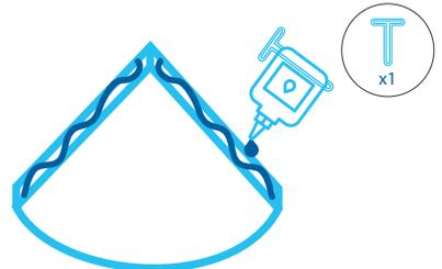
Retirer l'étagère des supports et appliquer le colle de scellement (C - fournie) dans les fentes de l'étagère, en s'aidant, si nécessaire, de la pince (F - fournie) pour pincer le tube. En cas de positionnement dans la cabine de douche ou dans des environnements en contact avec l'eau, assurez-vous de sceller tout le périmètre avec du silicone.
