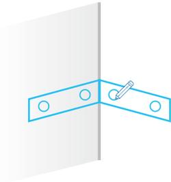
Appuyer le gabarit (E - fourni) sur les lignes horizontales tracées et, en exploitant les trous de celui-ci, marquer au crayon les 4 points (2 pour chaque ligne tracée) où les trous d'ancrage de l'étagère seront effectués.
