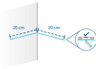
Une fois la hauteur souhaitée identifiée, à l'aide d'un niveau, tracez horizontalement une ligne d'environ 20 cm sur les deux murs, en partant du coin vers l'extérieur.
