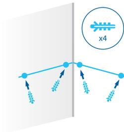
Une fois les trous effectués, insérez à l'intérieur les bouchons sous pression (D - fournis).
