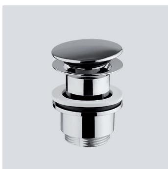
➤ Scarico per lavabo da 5/4" con comando a pressione, con troppopieno, spessore installazione 30-45 mm.
