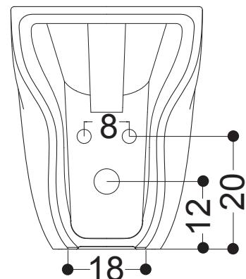
N.B.: Le misure indicate possono subire una variazione dello 0,8 % circa, dovuta ad usura stampi o a piccole variazioni delle caratteristiche tecniche relative alle materie prime che compongono l' impasto.
