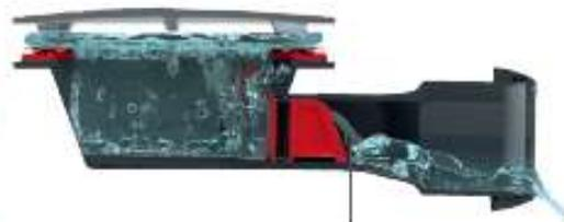
La membrana silicone si apre al passaggio dell'acqua, dopodiché si richiude per impedire la risalita di cattivi odori.
