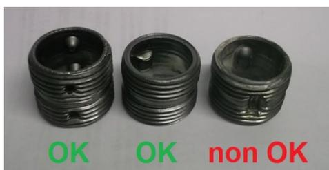
Attenzione: non utilizzare prodotti per la tenuta idraulica quali canapa, mastice o similari perché compromettono la tenuta del sistema di Elite Plus costituito dai nipples + o-ring originali. Elite Plus declina ogni responsabilità per perdite o altri inconvenienti causati dall'uso di questi materiali ed il loro impegno fa decadere la garanzia sul prodotto.
