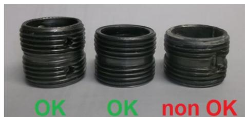
A lato si rappresentano due nipples originali, che hanno la sede dell'o-ring (scanalatura centrale) ininterrotta su tutta la circonferenza ed un terzo nipple non conforme, con la sede dell'o-ring non adatta all'uso.
