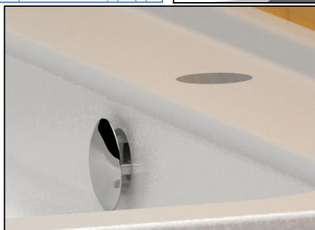
Il prodotto è studiato per coprire fori su bidet e lavabi in ceramica, ed è compatibile con fori da Ø 22 mm a Ø 26 mm con spessori di ceramica ≥8 mm e ≤11 mm.
